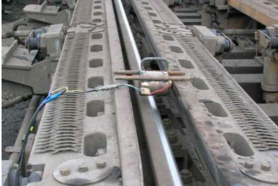
Рис. 2. Загальний вигляд металевого вкладиша з месдозою, встановленого на шини уповільнювача в незагальмованому стані:
