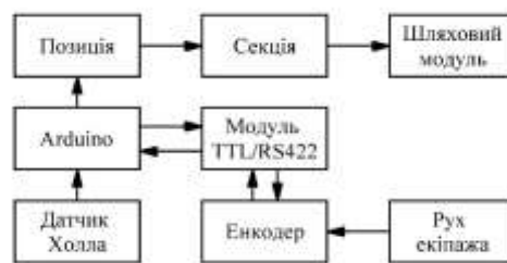
Рис. 8. Структура принципу координації натурального стенду
